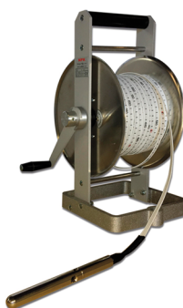
Sonde piezométrique Water level Gauge
