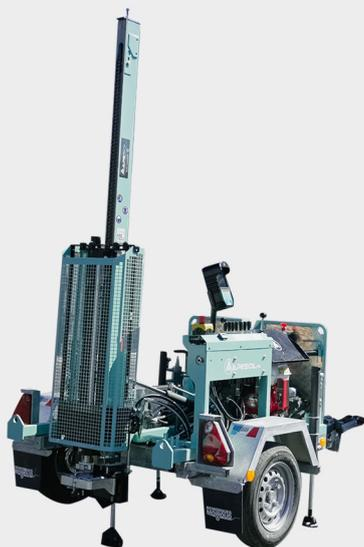
Le MAP55 est un pénétrömètre dynamique à énergie constante sur remorque routière. Il est tractable derrière un véhicule léger.
